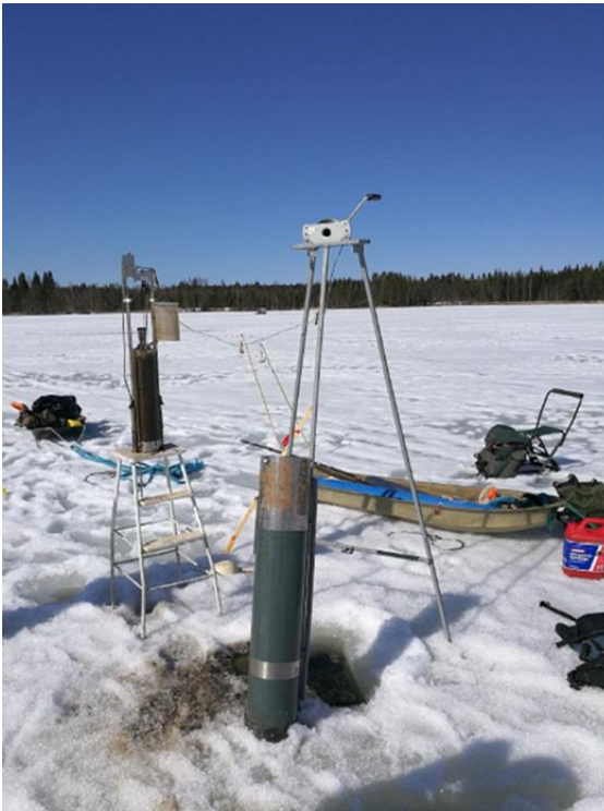
1. Pintasedimentin hapetus-pelkistysasteen mittausta Kuonanjärvellä huhtikuussa 2018 (Kuva: Rico-Petteri Mutanen).
