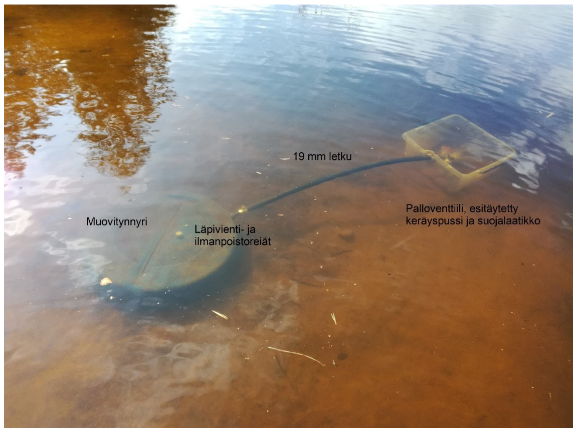
Kuva 19. Suotautumismittaus käynnissä Ristilahdella (kuva: Uusitalo J., 2018).
