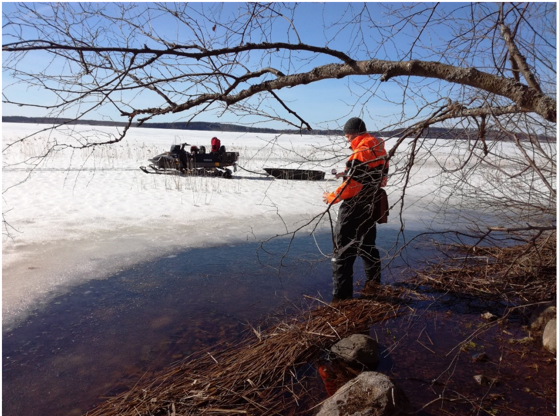
Kuva 12. Huokosvesinäytteenotto sulasta pohjaveden purkautumispaikasta Puruveden Ristilahdella (kuva: Nenonen N., 2018).
